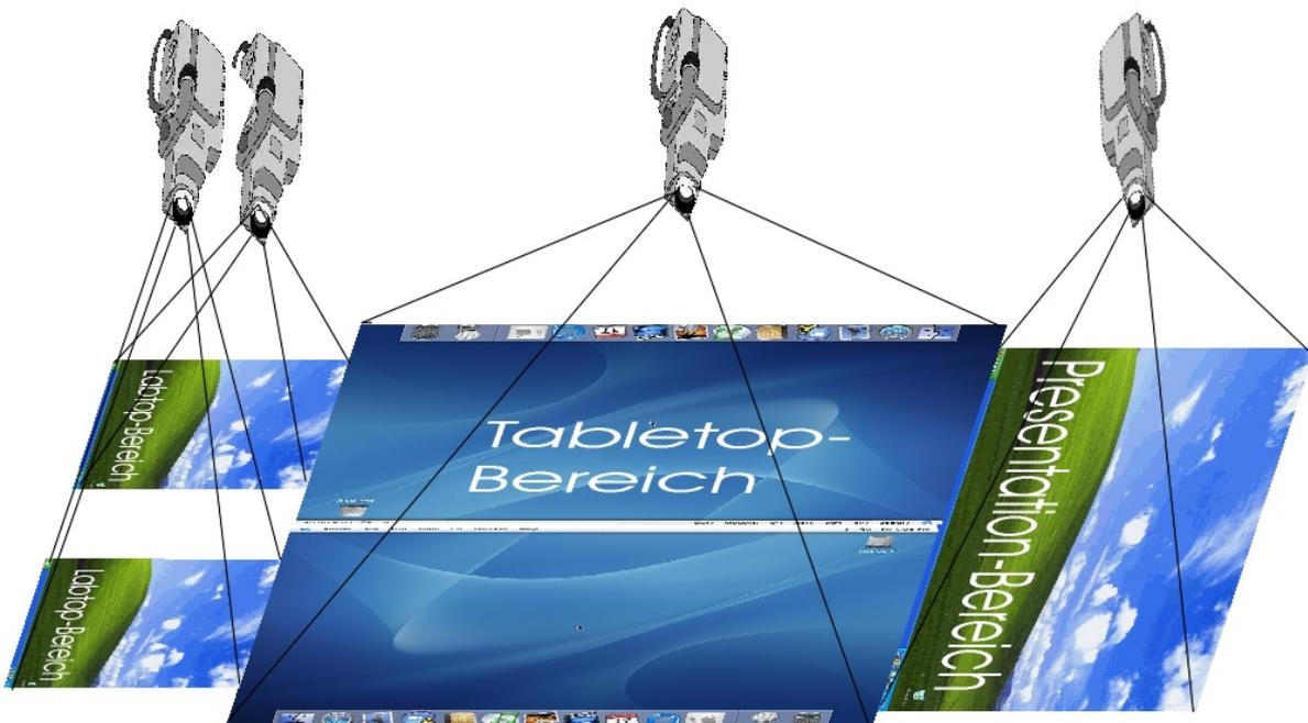
Abbildung 5.4: Jede Desktopkachel wird einem Viewport (Kameraobjekt) zugeordnet.
