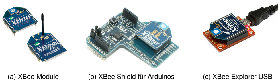
Abbildung 4.2.: Verwendete XBee Module und Shields 6
