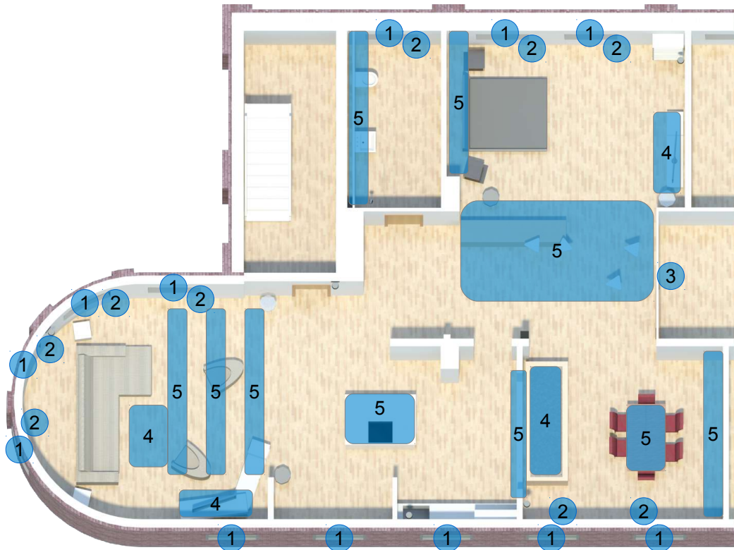
Abbildung 3.2: Laboratorik im Wohnbereich des Living Place Hamburg: [1] Fenstersteuerung [2] Heizungssteuerung [3] Türsteuerung [4] Anzeigegeräte [5] Lichtsteuerung
