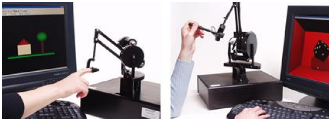
Abb. 7: PHANToM Modelle mit Tool- und Direktmanipulation 96
