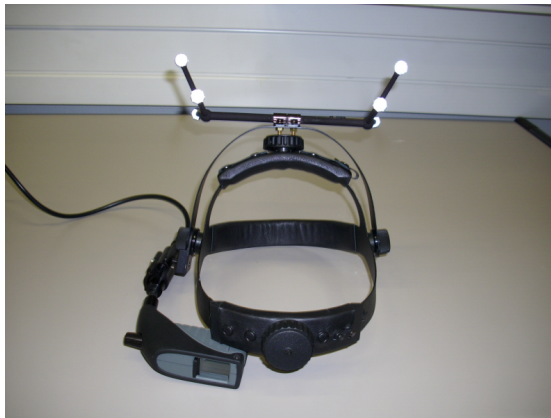
Abbildung 5.11: : Links: HUD mit ART-Artefakt Rechts: Grafische Darstellung des Joysticks aus der Physiksimulation
