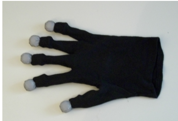
Abbildung 4.2: : Selbstgebauter Handschuh mit Markern
