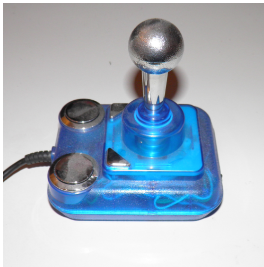
Abbildung 2.7: : Foto eines Joysticks mit diskretem Schaltverhalten
