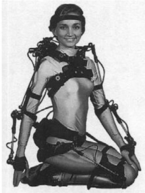
Abbildung 2.2.: Elektromechanisches Trackingsystem<sup>3</sup>
