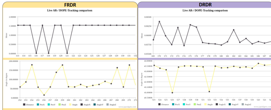
Abbildung 3.14: "DR vs. FR"-Vergleich "verdeckt"- Distanz (oben) - Winkel (unten) mit Messwerttrauschen
