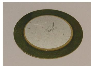
Abbildung 19: Ferroelektrischer Lautsprecher
