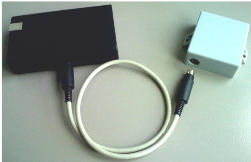
Abbildung 7.12: Prototyp 1 - AVR Sensorbox mit externem Bluetoothmodul
