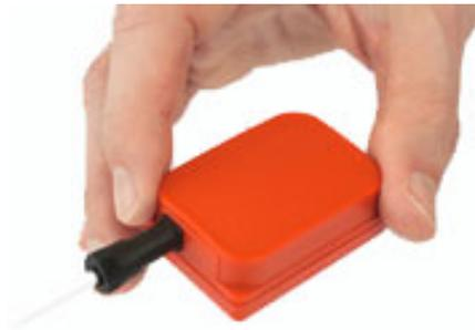
Abbildung 3.7: Xsens MTx Sensoreinheit [97]
