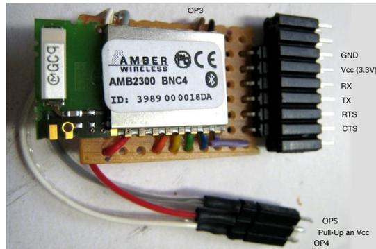
Abbildung 7.9: BlueNiceCom4 Modul für drahtlose Übertragung
