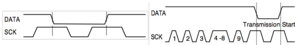
Abbildung 6.13: Start(links) und Reset(rechts) der Datenübertragung des SHT1x
