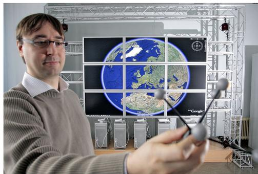
Abbildung 7: Powerwall mit IR-Marker
