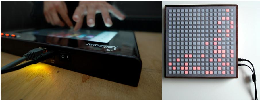
Abbildung 11: Lemur Multitouch Controller der Firma JazzMutant, monome Interface von Crabtree und Cain, basierend auf dem OSC Kommunikationsprotokoll
