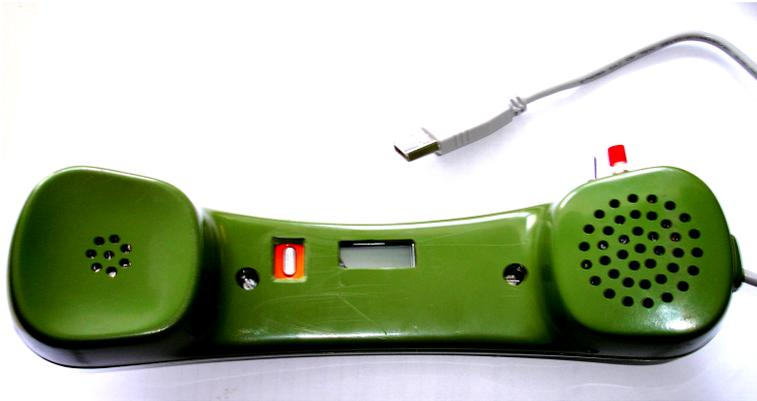
Abbildung 5: Hardware zum Mitschneiden von Telefongesprächen für die "voice.decoder.2" Installation
