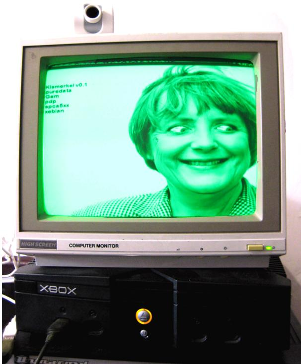
Abbildung 12: "Proof Of Concept" zur Lauffähigkeit von quelloffenen interaktiven multimedialen Anwendungen auf der Microsoft XBOX Spielekonsole. Das Gesicht auf dem Bildschirm verfolgt mit seinen Augen den Zuschauer. Das Gerät startet die Anwendung auf Knopfdruck. Motion-Tracking via USB-Webcam mit PureData, "Gem" und "PDP" Videoerweiterungen, video4linux-Treiber und Debian-GNU/Linux
