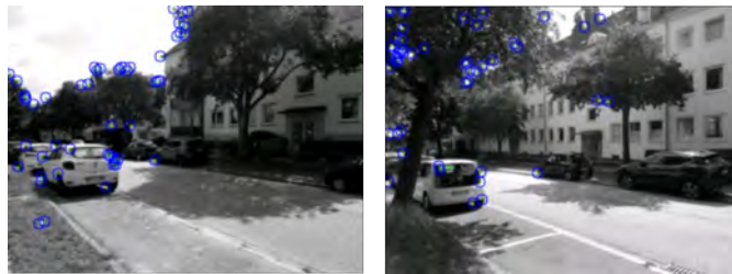
Abbildung 4.4: Extrahierte Merkmale für spärlichen optischen Fluss
