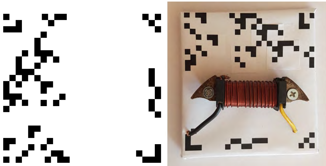
Abbildung 4.1.: a) Marker für das Tracking, b) Elektrische Spule auf Untergrund mit Marker
