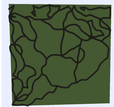
Abbildung 6.7: Straßennetz generiert mit möglichst offenen Parametern. Abweichwinkel: 50°; Minimalwinkel: 30°
