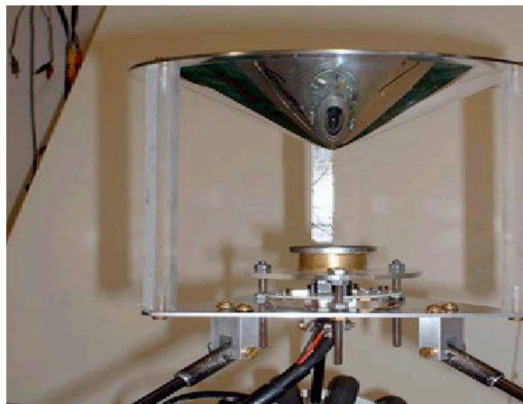
Abbildung 2.9: Omnidirectional Spiegel und Kamera der FU-Fighters [Petrov04].
