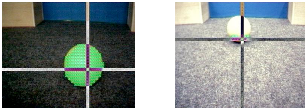
Abbildung 5.4: Die richtigen Parameter zu finden gestaltet sich bei automatischem Weißabgleich der Kamera und leichten Beleuchtungsveränderungen schwierig.
