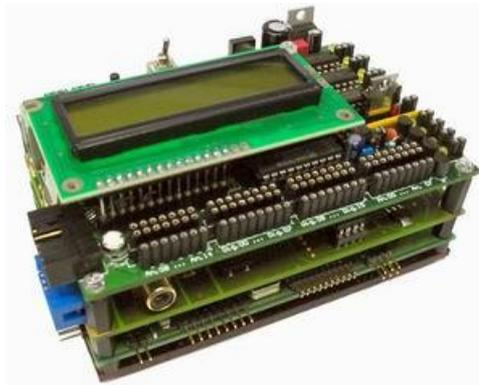
Abbildung 2.5 Rcube Roboter Plattform
