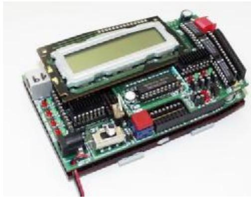
Abbildung 2.1 MIT 6.270 Roboter-Board
