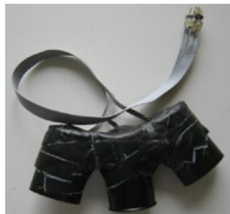
Abbildung 2.4: Beacon: Ist auf dem Roboter zu befestigen
