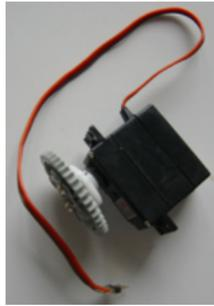
Abbildung 2.6: Motor: Von aussen identisch, wie ein Servo
