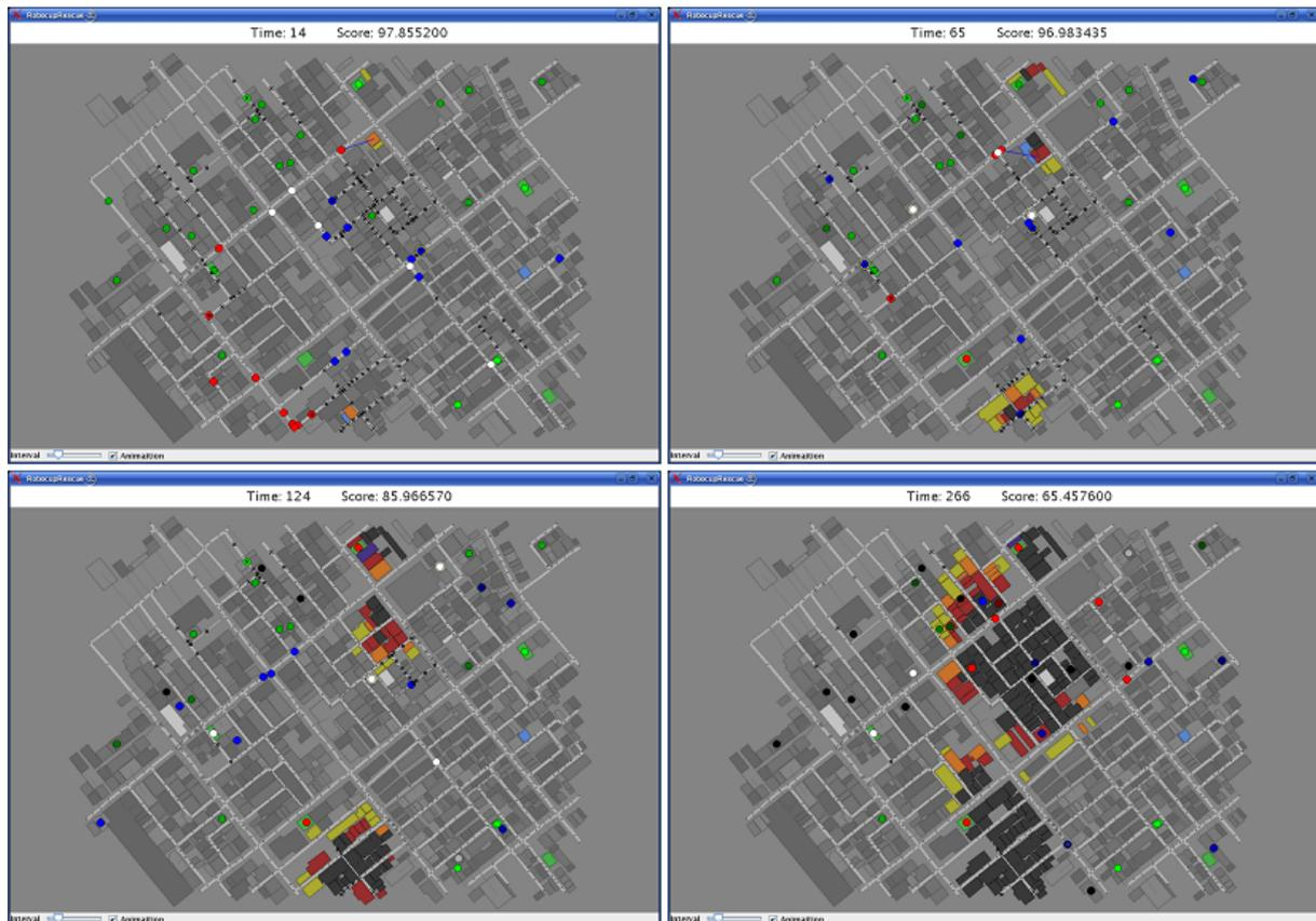
Abbildung 3.3: Ausbreitung und Verschmelzung von Feuerherden
