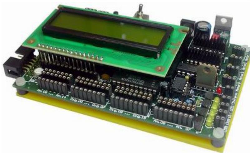
Das Board verfügt über analoge und digitale Eingänge, sowie über 4 Ausgänge, an denen jeweils ein Motor angeschlossen werden kann und zusätzlich noch über die Möglichkeit, Modellbau-Servos anzusteuern. Versorgt wird das Board von einem Modellbau-Akku, der zwischen den Plattformen der Roboters Platz findet:
