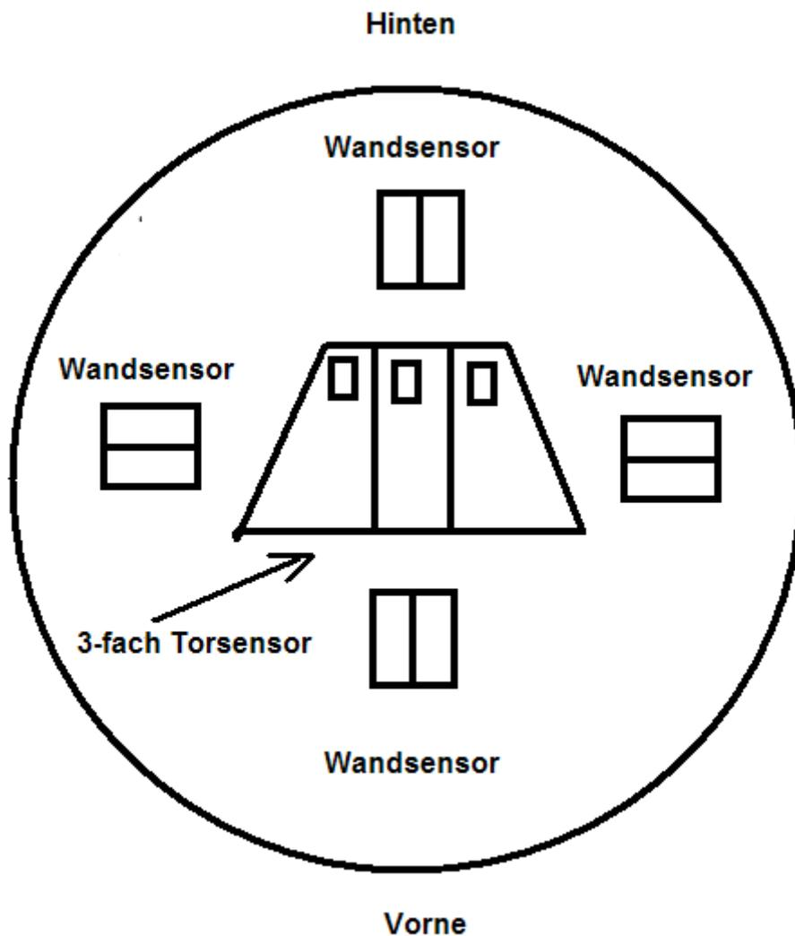
9 Ballsensoren sind um die Plattform verteilt angebracht, die geben jeweils einen analogen Messwert an jeweils einen Eingang des Boards. Vorne sind drei Ballsensoren zusammen verbaut worden, sie sollen den Ball auch auf grössere Entfernung erkennen:
