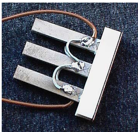
Abbildung 5.4: Anschluss des Transducers
