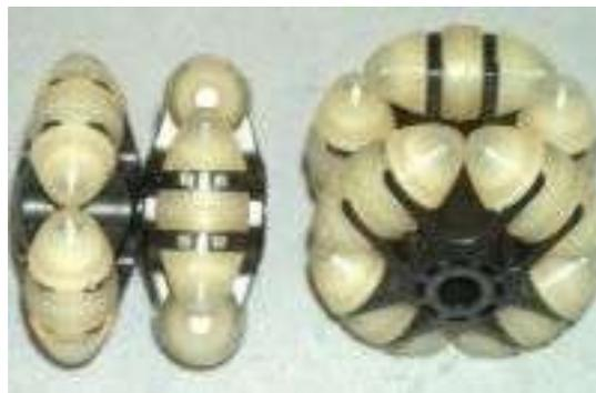
Abbildung 5.3: Roboter - Allseitenräder
