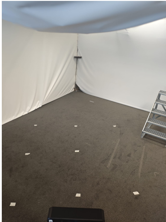
Abbildung 3.3: Aufbau der ersten Testumgebung mit Koordinatenmarkierungen. Fotografiert von direkt oberhalb der Stereokamera
