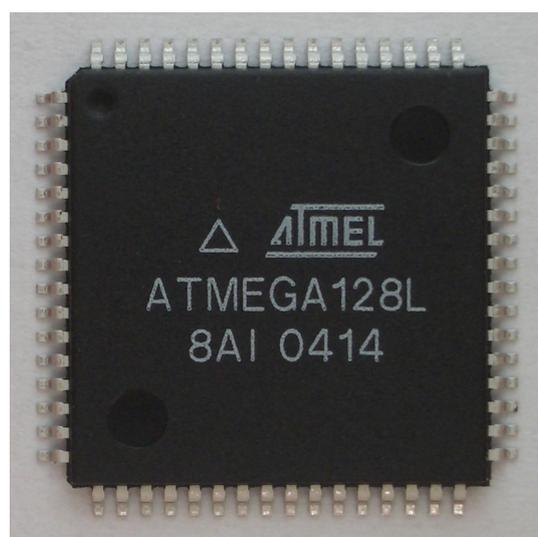
Abbildung 30: ATMEL ATmega128L im MLF-Gehäuse
