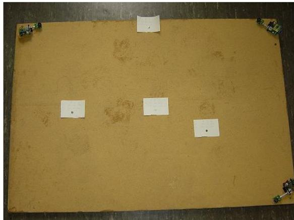
Abbildung 6.1: Versuchsaufbau - Bodenplatte (100cm x 80cm) mit diversen Testpositionen und drei Beacons
