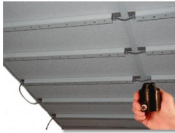
Abbildung 3.5: HiBall Beacon Deckeninstallation
