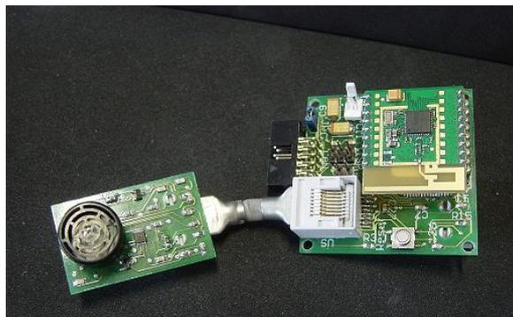
Abbildung 5.13: IMAPS: Grundplatine steckbar mit Listener
