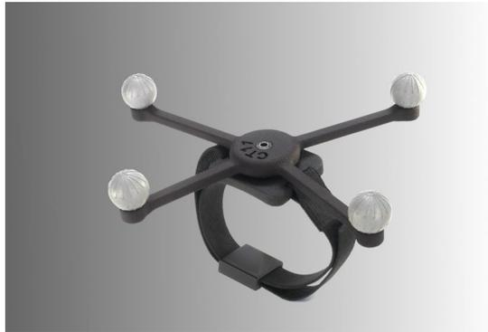
Abbildung 2.3: AR-Tracking - passives Clawtarget ([Advanced Realtime Tracking GmbH](#))
