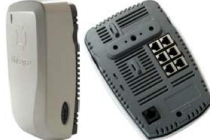
Art Beacon Signal aussenden. Anhand dieses Signales welches über die Referenzpunkte eingefangen wird, ist eine zentrale Location Engine in der Lage, die Position jedes Tags zu bestimmen. Die Position eines Tags wird im Ubisense-System mittels einer Kombination aus AOA- und TDOA-Algorithmen realisiert. Um die Zeitsynchronisation zwischen den Referenzpunkten sicherzustellen werden die Referenzpunkte mit einer Timing Leitung verbunden.
