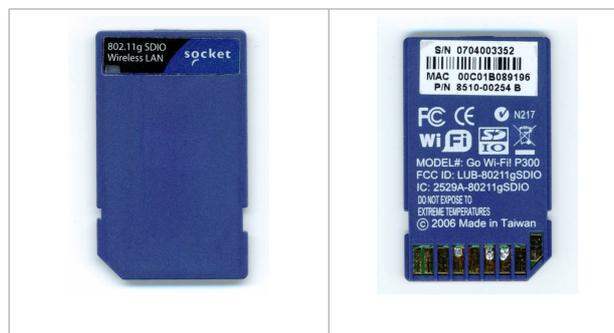
Abbildung 50: SD/IO WLAN-Karte von Socket
