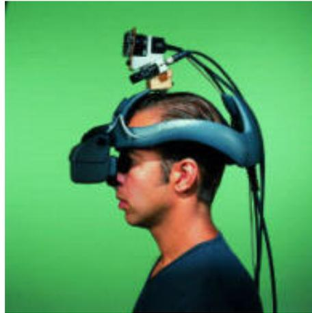
Abbildung 4.12: Beispiel eines HMD's mit Kamera
