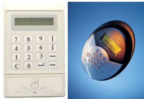
Abbildung 4-6: RFID-Lesegeräte mit Ziffernblock der Firma cavitec [CAVI-1] (links) und der Firma TimeLink International [TIME-1] (rechts)
