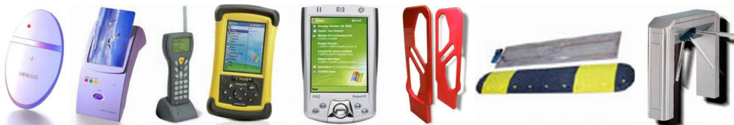
Abbildung 4-2: Verschiedene RFID-Lesegeräte der Firmen EHAG Electronic Hardware [EHAG-1] und TAGnology RFID Limited [TAGN-1]
