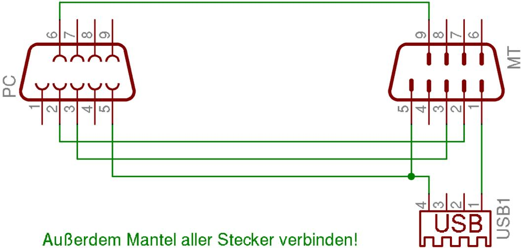
Abbildung A.1: Schaltplan für Adapter zur Stromversorgung per USB
