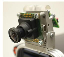
Abbildung 2: CCD-Kamera (iDS UI-1226LE-M-GL)
