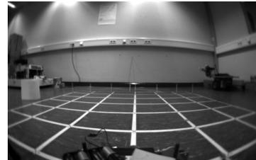
Abbildung 1: Kamerabild mit Linsenverzerrung
