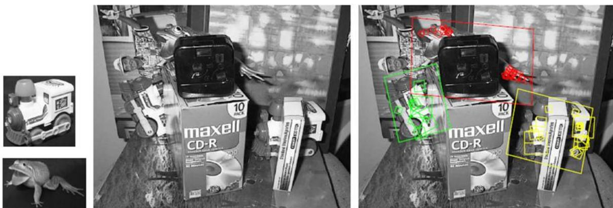
Abb. 2: Beispiel einer SIFT Anwendung - Links sind zwei Referenz-Abbildungen zu sehen. In der der Mitte sieht man das Vergleichsbild, in dem die Objekte gefunden werden sollen. Auf der rechten Abbildung wurden die gefundenen Objekte markiert. Die kleinen Rechtecke verweisen auf die Key-Points, die zur Identifikation dienen.
