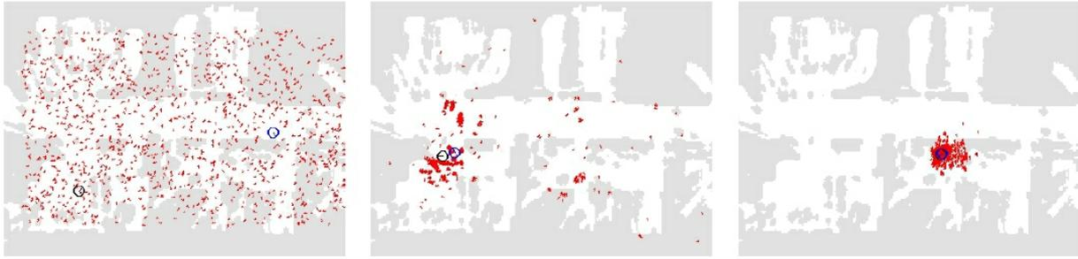
Abb. 10: Anordnung der Samples bei Initialisierung, nach vier und nach 35 Iterationen
