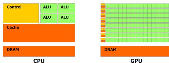
Abbildung E.1.: Schematischer HW-Aufbau einer CPU und einer GPU
