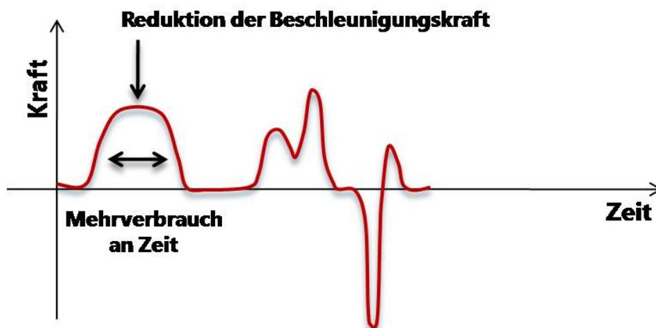
Abbildung 4.1: Auswirkungen einer Geschwindigkeitsreduktion auf die Beschleunigungskraft
