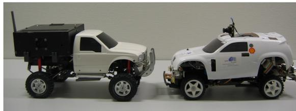
Abbildung 1.1: Autonome Modellfahrzeuge im FAUST-Projekt
