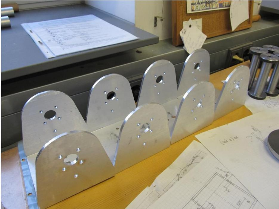
Abbildung 7-5 Schultergelenke aus der CNC Fräse
