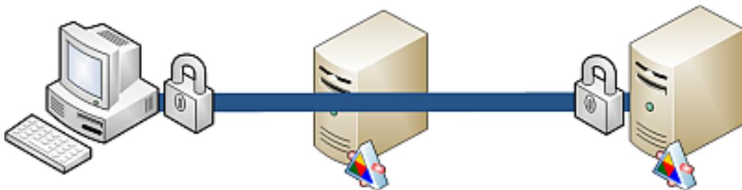
Abbildung 2.4: Ende-zu-Ende Verbindung mit WS-Security Verschlüsselung
