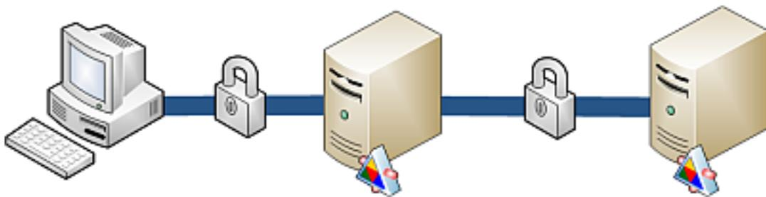
Abbildung 2.1: SSL Verschlüsselung mit Intermediary
