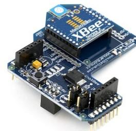
Abbildung 7: xBee Shield mit xBee Modul (11)
