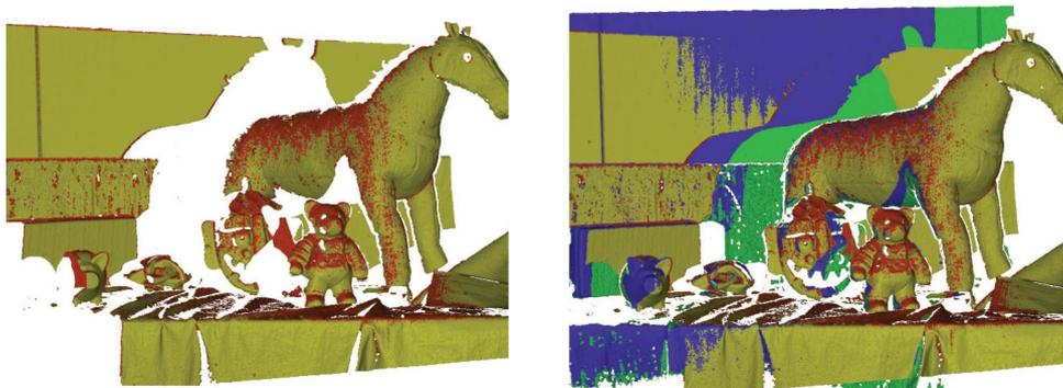
**Abb. 6.** Rekonstruierte Punktwolken unter Benutzung von 2 (links) und 4 Scaneinheiten (rechts). Quelle: [IS12] (Ausschnitt)
