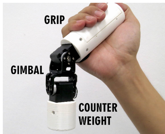
Abb. 2. 'Bottomless Joystick' [10], Adaption eines herkömmlichen Joysticks für VR
