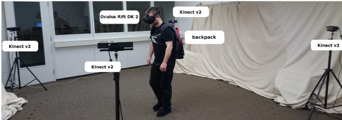
Abbildung 2: Laboraufbau: Der Nutzer trägt eine VR Brille mit einem Notebook im Rucksack. Dabei wird er von vier Kinects v2 getracket [12]
