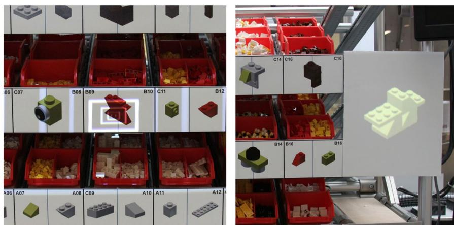
Abbildung 4.2: Projektionsbasierter Versuch: Bauteil Markierung und Montage Anweisungen
